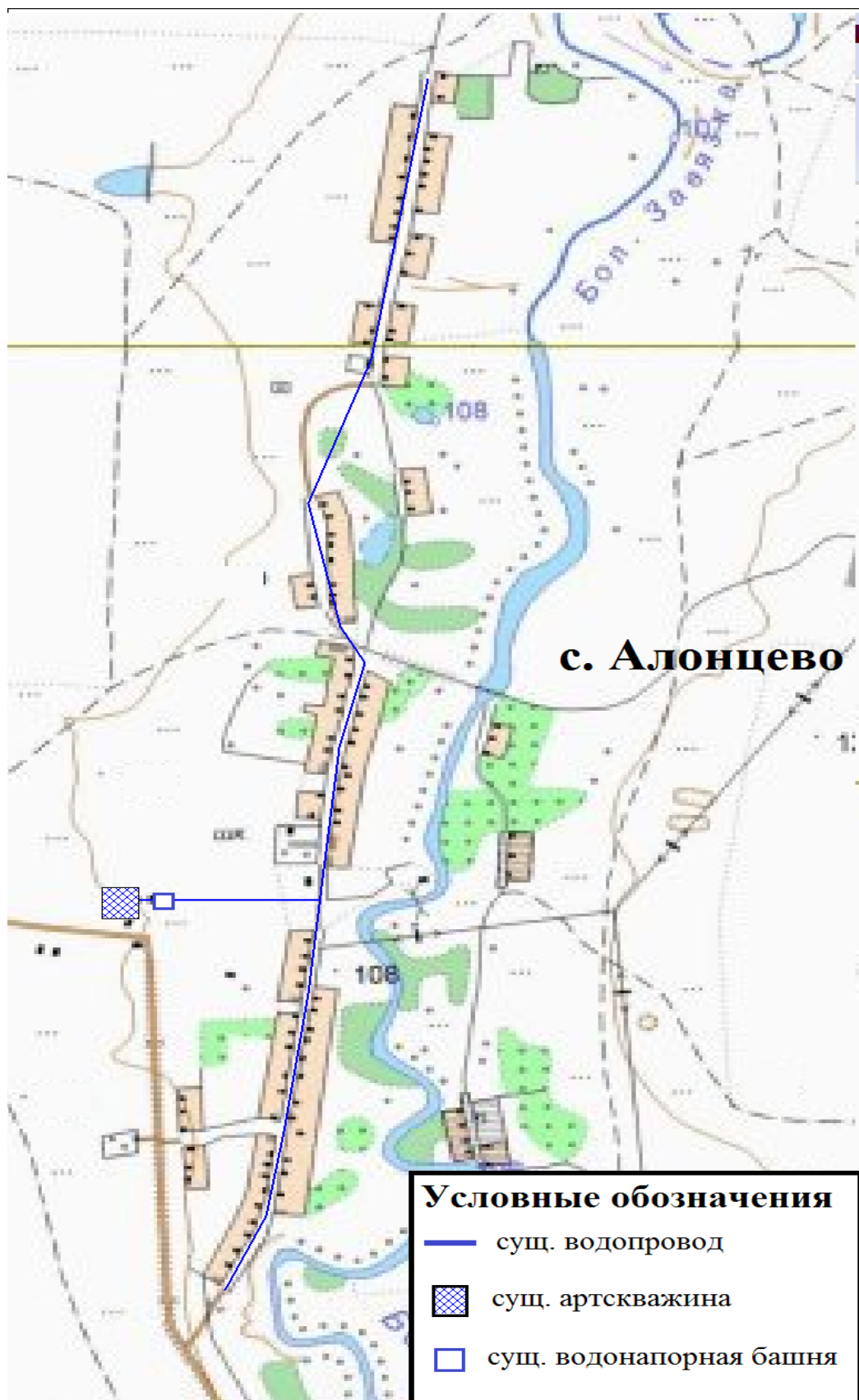
Рис. 4 Существующая система водоснабжения с. Алонцево
